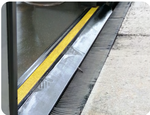
Bourrelets en caoutchouc placés sur le quai et le tram
