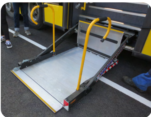
Plateforme élévatrice pour permettre l'embarquement des voyageurs PMR
